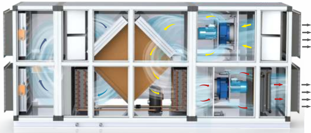
Схема распределения воздуха в агрегате климатическом серии «ATLANTIS»
