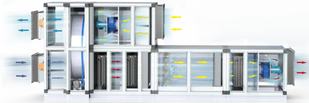
Схема распределения воздуха в центральном кондиционере
