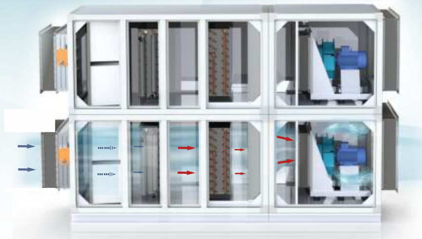
Схема распределения воздуха в приточном агрегате климатическом для нефтехимической, газовой, энергетической отраслей и АЭС
