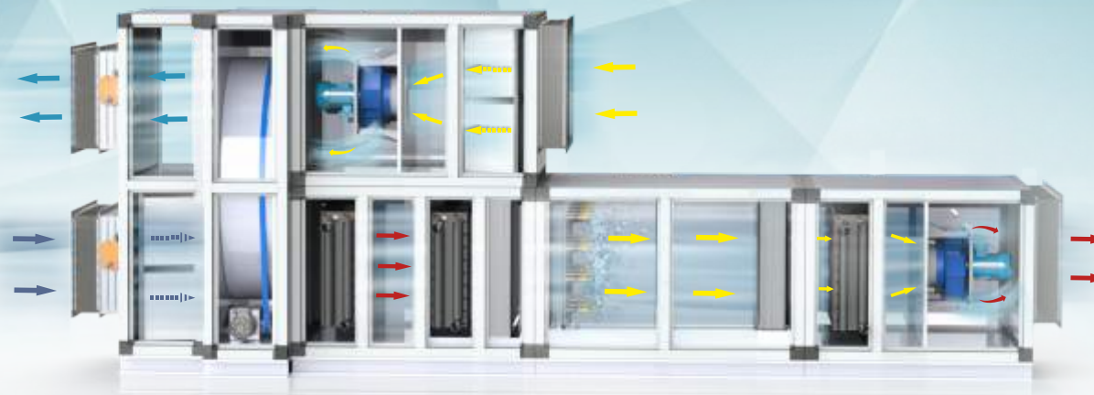
Схема распределения воздуха в центральном кондиционере
