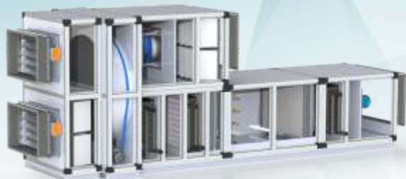
Центральный кондиционер приточно-вытяжной с рекуператором, секцией осушения и форсуночной камерой
